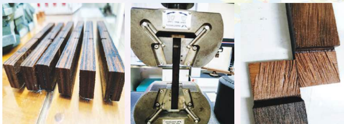
Hình 5: Thí nghiệm xác định chất lượng dán dính
