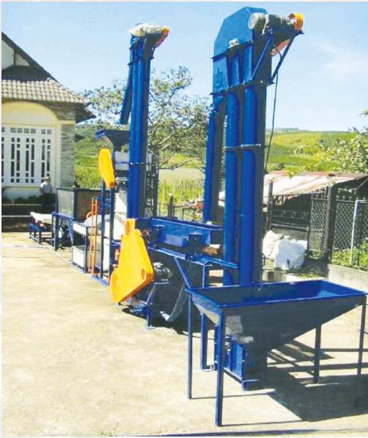
Hình 1: Hệ thống thiết bị chế biến ướt cà phê do công ty TNHH Viết Hiền chế tạo
